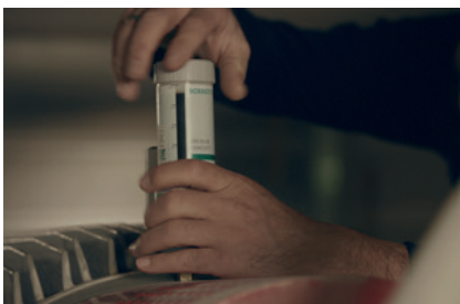
Der OPTIME C1 wird montiert.
