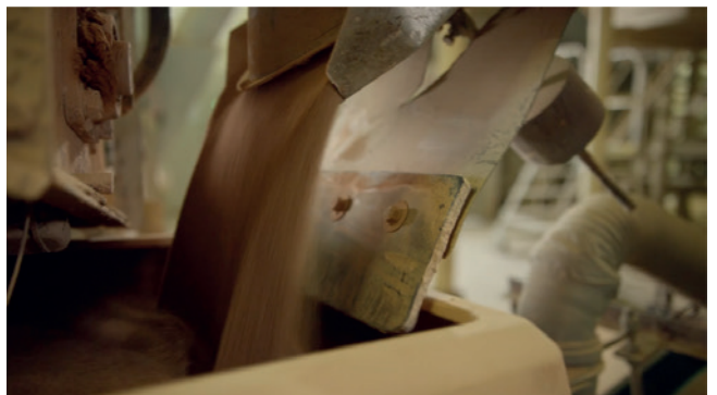
Granulat tritt aus dem Sprühturm aus
