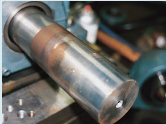
Typische Passungsrost und Wellenschäden eines Lagers mit Feststellschrauben-Befestigung
