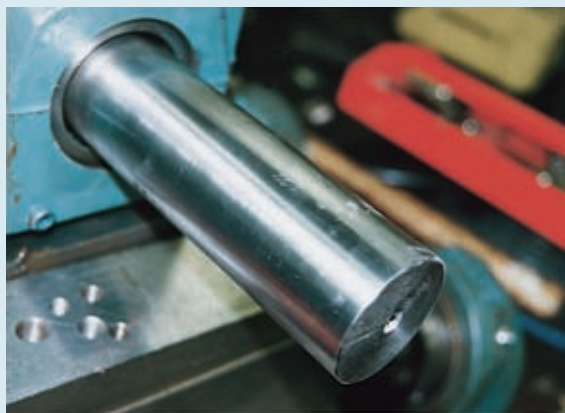
Keine Passungsrost oder Wellenschäden bei der GRIP TIGHT Adapter-Lagerbaugruppe
